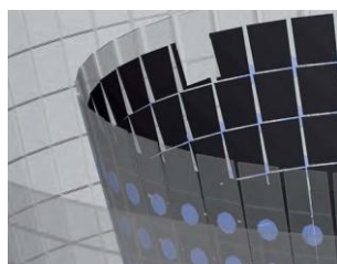
شکل ۳: پروژه مرکز اسناد، ورقه های مستقر در نما برای جذب انرژی خورشیدی (Ritter, ۲۰۰۷)
