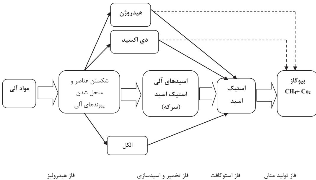
شکل ۲: مراحل هضم بی‌هوایی عناصر آلی (تولید بیوگاز)
