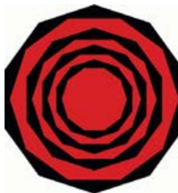
تصویر شماره ۳. ساختار بیرونی و درونی گنبد به شکل چند ضلعی منتظم
