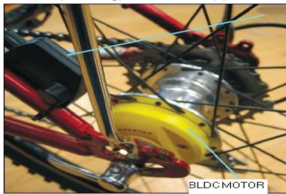
شکل ۴. موتور BLDC در هاب چرخ عقب دوچرخه [۱۰]
